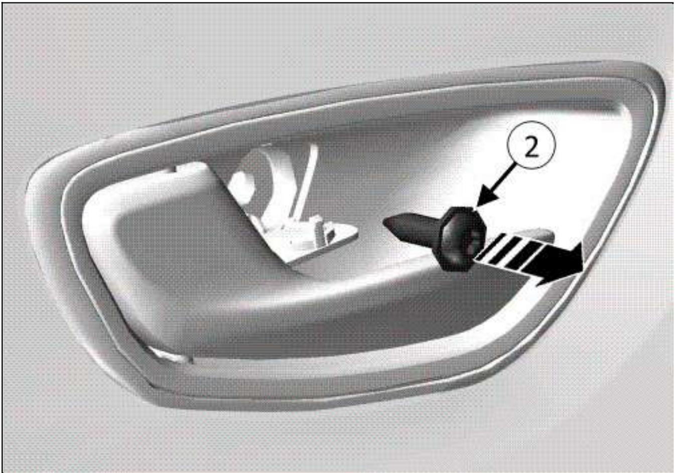
■ Die Befestigungsschraube(2) entfernen.
