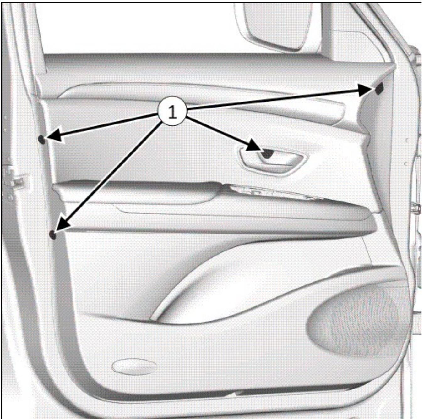
■ Die Stopfen(1) der Schrauben der Türverkleidung vorne entfernen.
