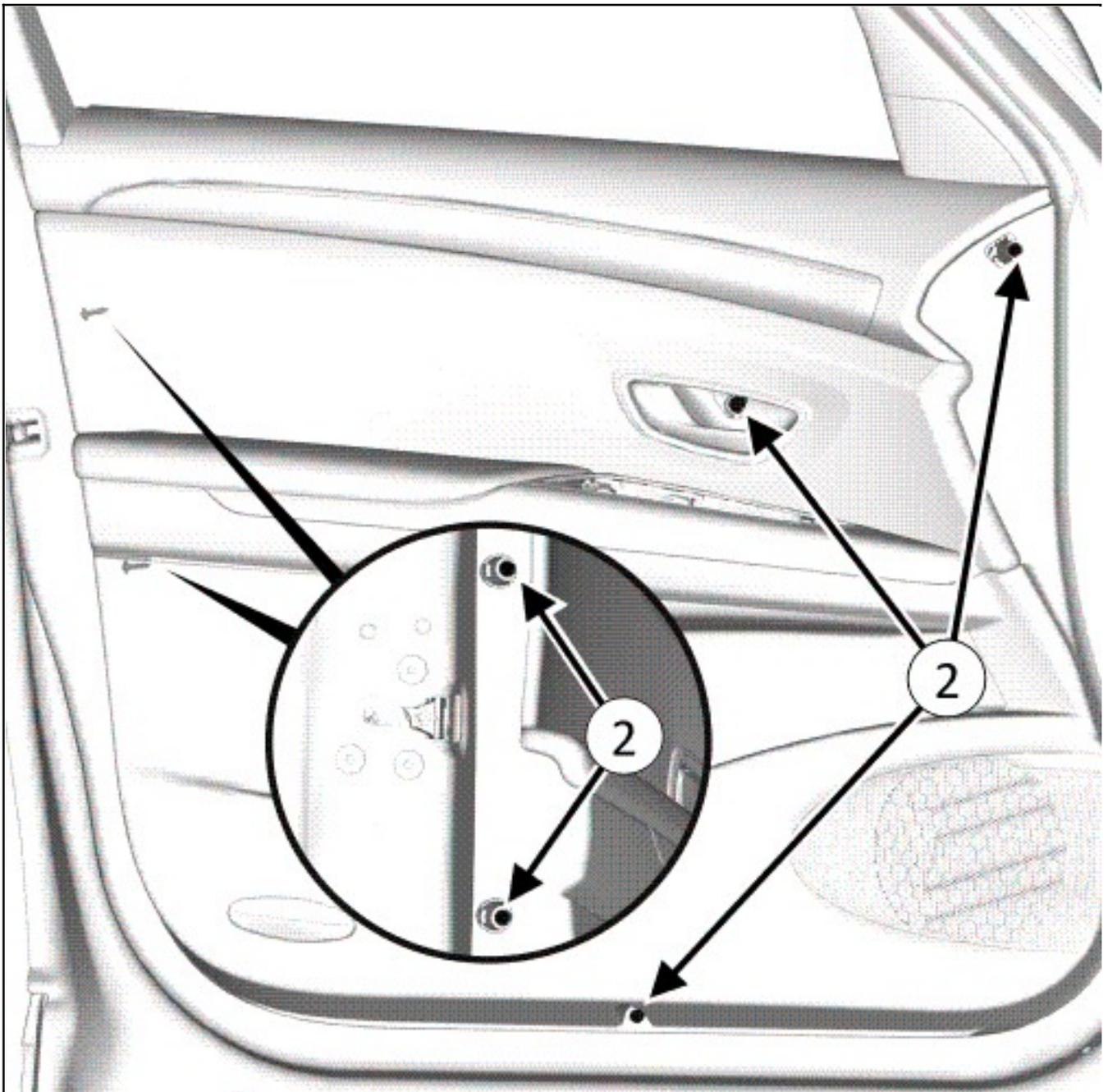
■ Die Schrauben entfernen.(2) die Türverkleidung vorne.
