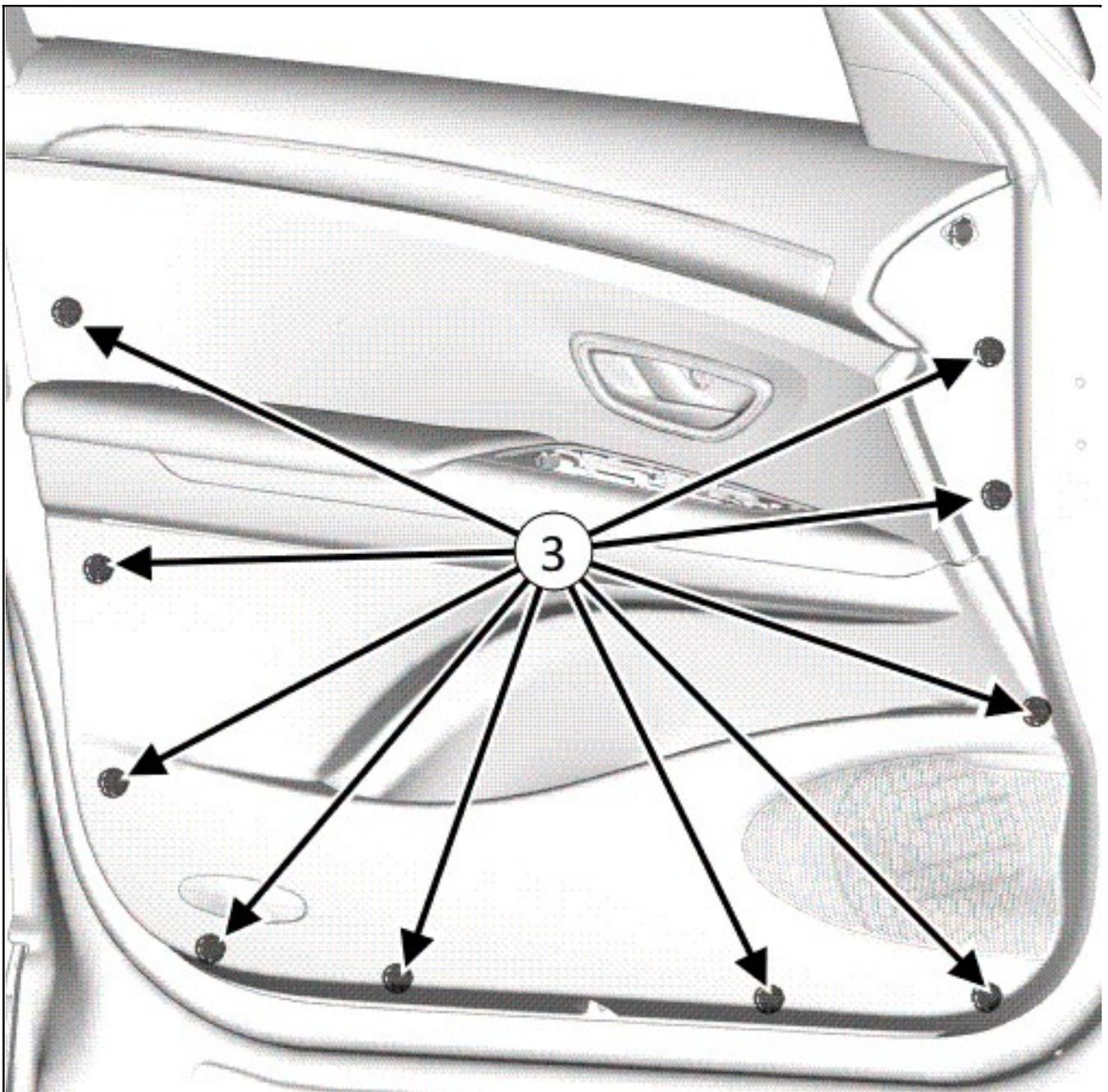
■ Die Klammern ausrasten,(3) der Türverkleidung vorne unter Verwendung des Werkzeugsatz Hebel zum Abgarnieren.(Car.1363 ).
