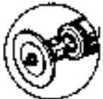
Die Schweißnaht bzw. Schweißpunkte abschleifen. Einhand-Gerad-Schleifer, versehen mit einer Bakelit-Scheibe,  $\varnothing$  75, 1,8 bis 3,2 mm Stärke (feste Scheibe).
