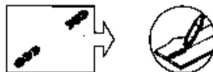
**3** VERBINDUNG MIT DER MITTLEREN VERBINDUNGSLASCHE HINTEN
