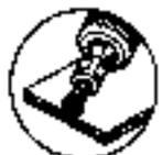
Die Schweißpunkte mit Fräser lösen. Einhand-Gerad-Schleifer 20 000 /min versehen mit einem Kugelkopffräser (Wolfram);  $\varnothing$  10 oder 16 mm.
