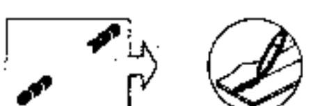
**2** VERBINDUNG MIT DER VORDEREN PARTIE DES EINSTIEGSCHWELLERBLECHS
