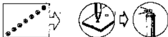
**3** VERBINDUNG MIT DER VORDEREN PARTIE DES VORDEREN LÄNGSTRÄGERS
