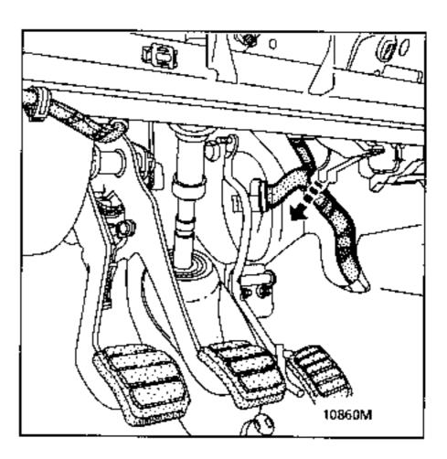
Prüfen, ob zwischen Kabelstrang Fahrgastraum und linkem unteren Winkel der Megabox keine Reibungspunkte bestehen.
