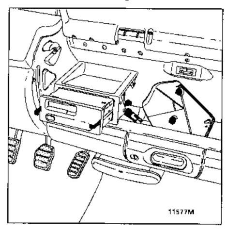
Den Metallrahmen mit Gehäuse ausbauen (2 seitliche und 2 senkrechte Schrauben).
