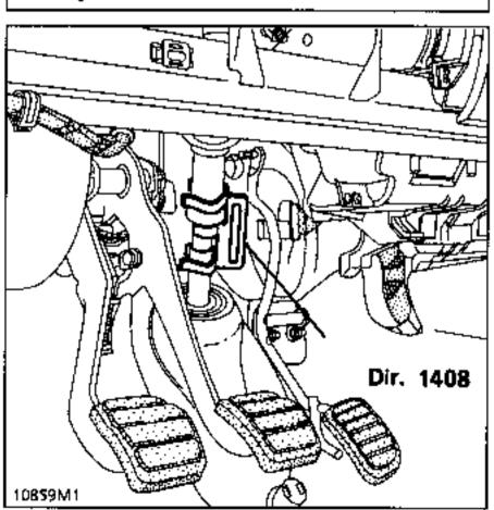
Den Bolzen des Lenksäulengelenks festziehen.
