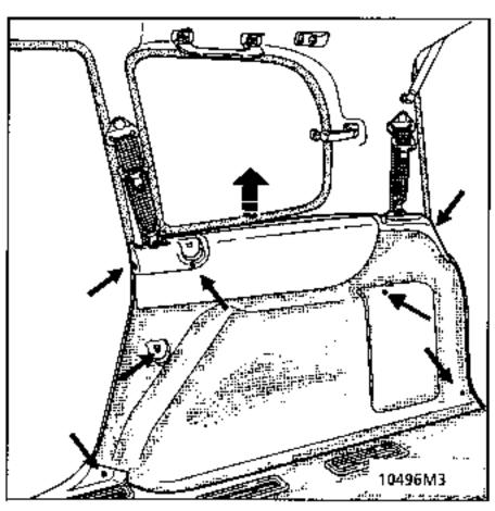
Die obere hintere Befestigung der Verkleidung, zuvor das Gitter mit einem kleinen Schraubendreher lösen.
