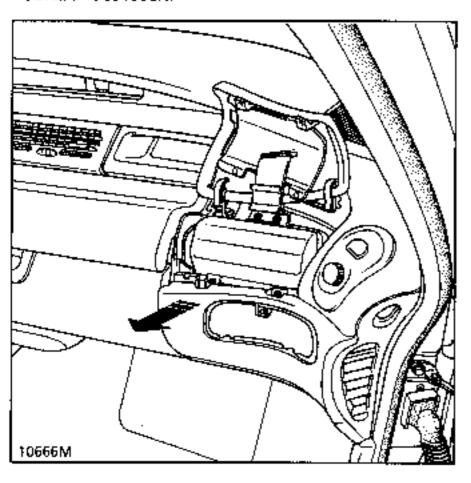
EINBAU DER ABDECKUNG DES BEIFAHRER-AIRBAGS
