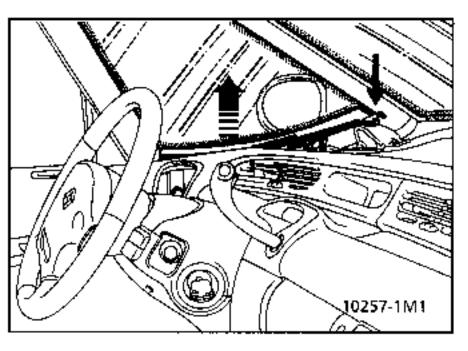
Die beiden seitlichen Befestigungen der oberen Armaturenbrett-Partie losschrauben und die beiden Laschen lösen.
