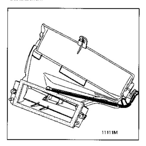
Die Abdeckung des Informationsdisplays lösen und nach vorne drücken; sie beim Einbau an der Zentrierung ausrichten.
