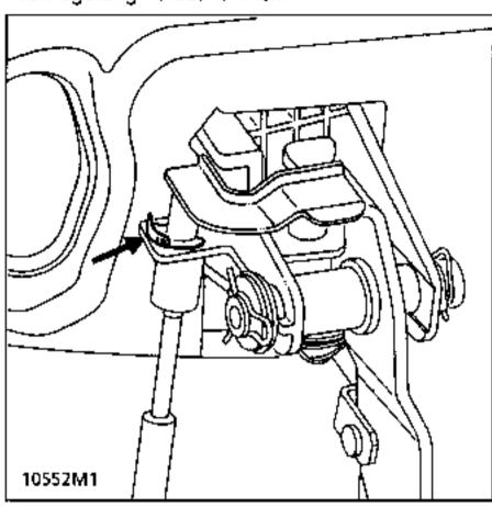
Um zu vermeiden, daß die beiden mittleren Luftklappen zerbrechen, die Betätigung in Position "geschlossen" (A) bringen.
