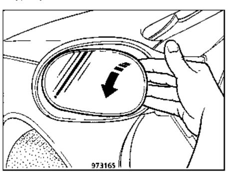
Den Rückspiegel nach innen kippen. Wie abgebildet, von außen auf das Spiegelglas drücken, so daß man mit den Fingerspitzen unter das Glas fassen kann.
