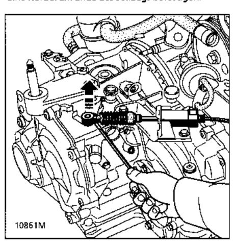
Die Hüllenarretierung mit einem kurzen Schraubendreher lösen.
