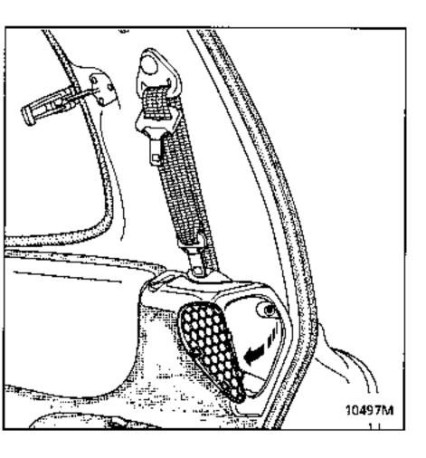
Die gesamte Verkleidung anheben, um die vier Kunststoffklammern der oberen Halterung zu entfernen
