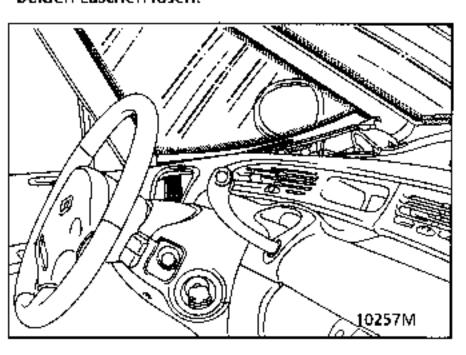
Die T-Stücke der Entfrostung (2 Blechschrauben) lösen und sie nach vorne herausziehen.
