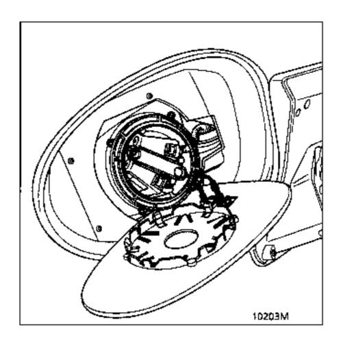
Bei dem elektrisch verstellbaren Rückspiegel den Kabelstrang für die Beheizung abziehen.
