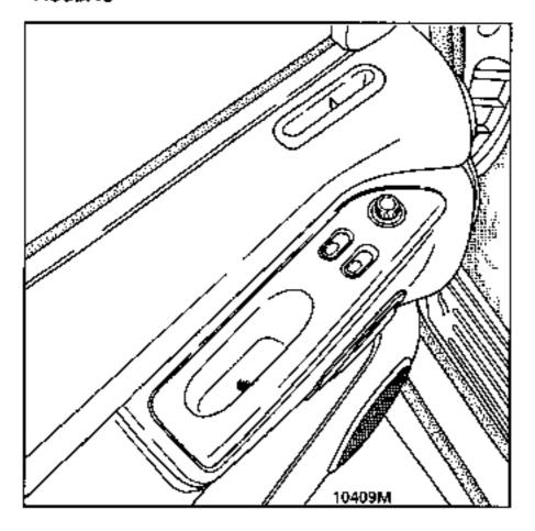
Den Betätigungseinheit an der Tür (eine Torxschraube 20).
