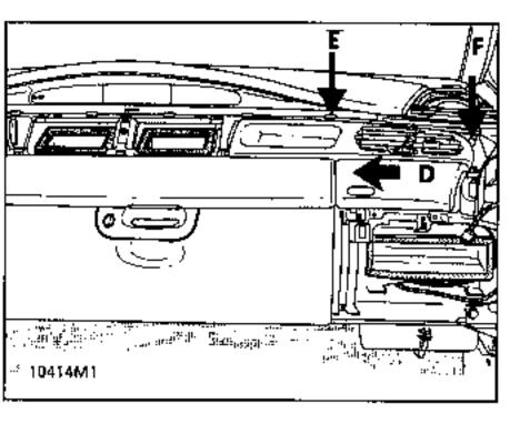
Die Kugelkopf des Gestänges lösen, dabei auf die untere Partie drücken und die Düse herausnehmen.
