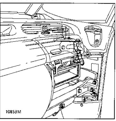
Das Armaturenbrett von den vier Stiften (B) lösen, dabei die beiden Einstellungen der vorderen Gurte maximal anheben.
