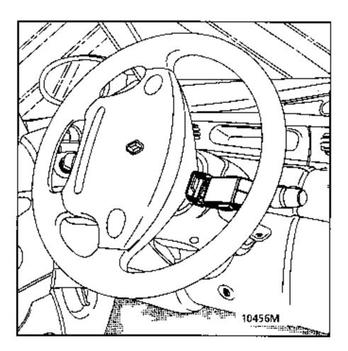
Die untere Halbschale herausnehmen, dabei das Kabel der Fernbedienung entfernen.
