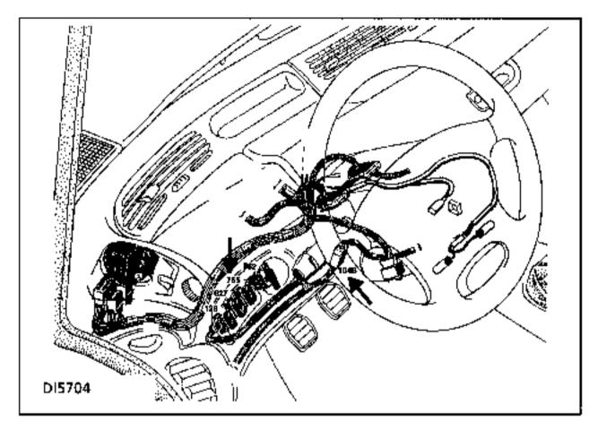
Kabelstrang Schalter der unteren Konsole Fahrerseite 128 - 627 - 755 - 562.
