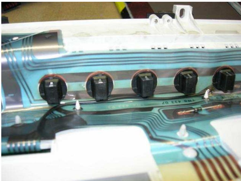
Das Kabel ist im Steckerbereich an der ganz rechten Leiterbahn angelötet. Wer es nachmacht, braucht ja nur die Leiterbahn zu verfolgen. Das Display ist, wie der Rest des Wagens von 5/98 (also noch Steinzeitverdrahtung).
