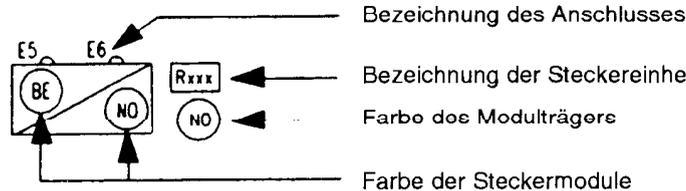
Bei dieser Darstellungsweise ist eines der Steckermodule nicht abnehmbar; meist ist dies das schwarze Steckermodul (= NO). Das gegenüberliegende, meist andersfarbige Steckermodul hingegen kann abgenommen werden.
