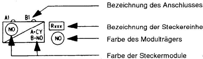
Bei dieser Darstellung ist das schwarze Steckermodul ebenfalls nicht abnehmbar. Ihm gegenüber sind jedoch zwei verschiedenfarbige Steckermodule angeordnet. Jedem dieser abnehmbaren Steckermodule sind die Anschlüsse mit dem gleichen Buchstaben zugeordnet. Entsprechend nebenstehendem Beispiel sind demnach:
