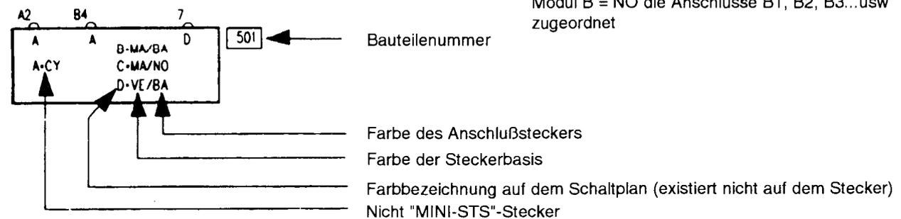
An einigen elektronischen Steuergeräten befinden sich sogenannte "MINI-ST5"-Stecker. In den Schaltplänen wird grundsätzlich die Farbe der Steckerbasis sowie die Farbe des sichtbaren Steckerteils angegeben.
