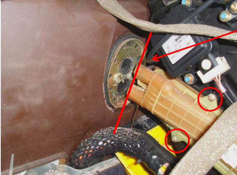
Anschlussstutzen vom alten Wärmetauscher absägen
