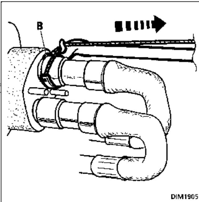
Zum Lösen der Verschlüsse auf die Klampen (3) drücken und gleichzeitig die Leitungen (1) auseinander ziehen.
