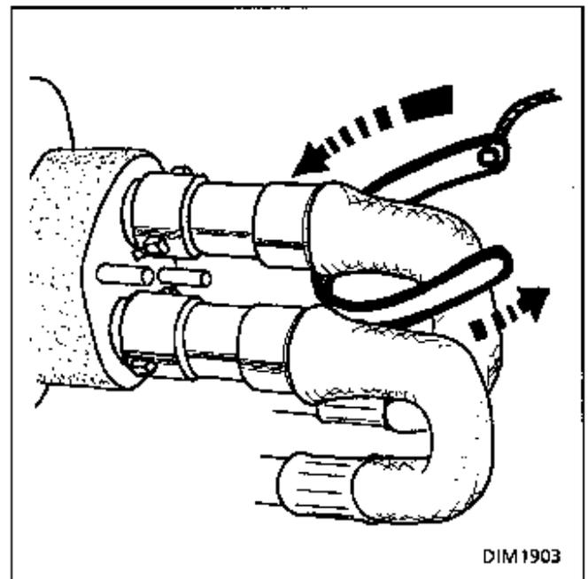
Das Kabel in den Winkeltrieb (A) einschieben.
