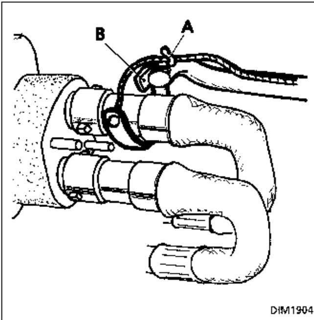
Das Horn (B) hinter den Anschluß klemmen. Gleichzeitig sehr vorsichtig am Schlauch und am Kabel ziehen.
