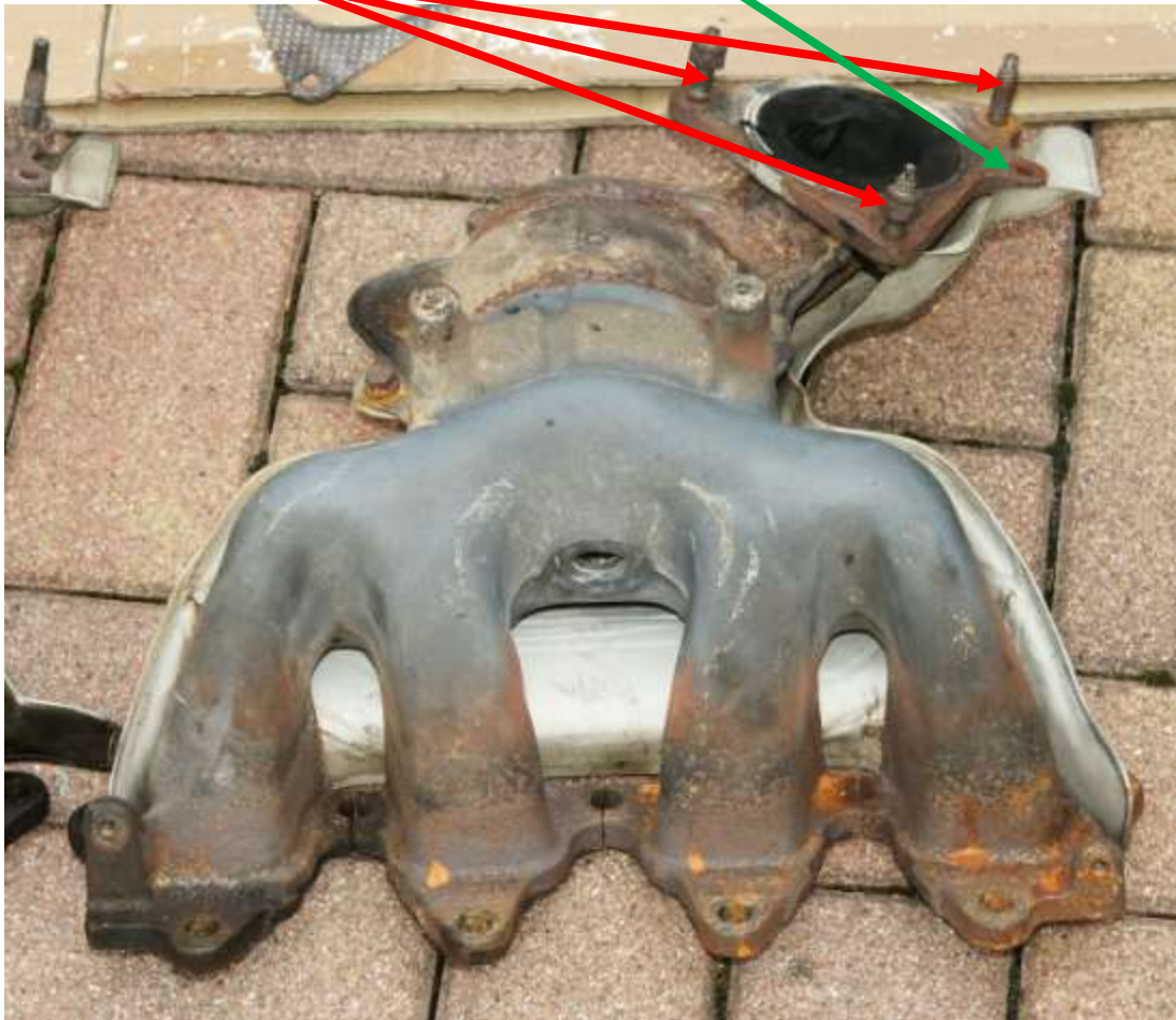
Abbildung 14: Krümmerschrauben zum Katalysator
