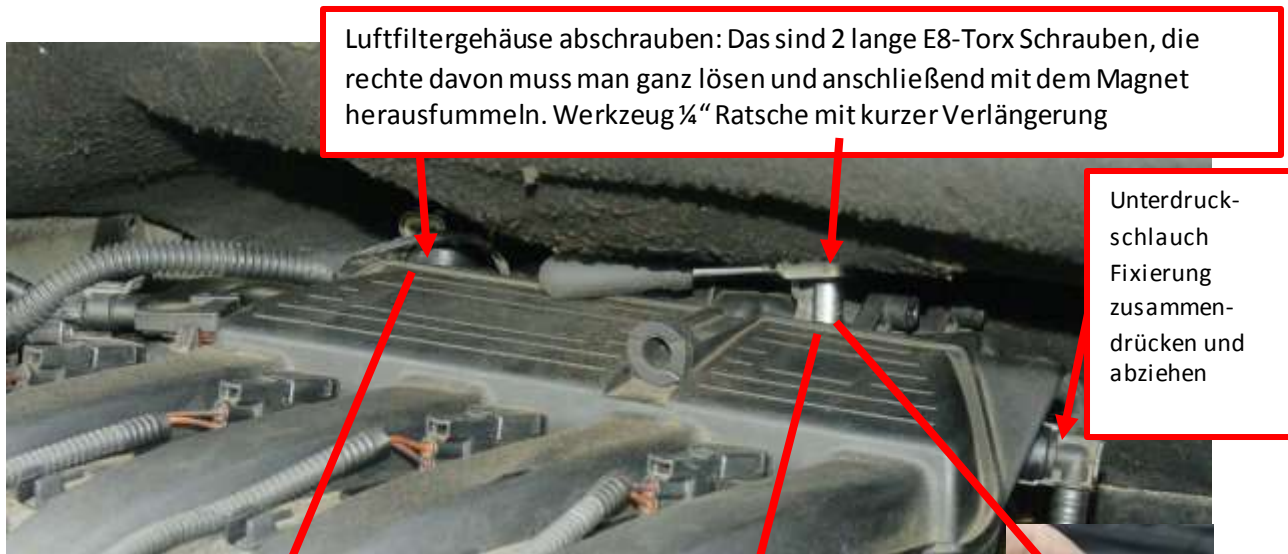
Abbildung 4: Luftfilterkasten Schrauben
