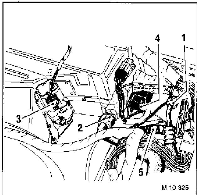
Die Verbindungsschläuche am Verdampfer (1) und (2) entfernen (an der Verdampferseite mit einem flachen Maulschlüssel gegenhalten, die Schläuche sind empfindlich).
