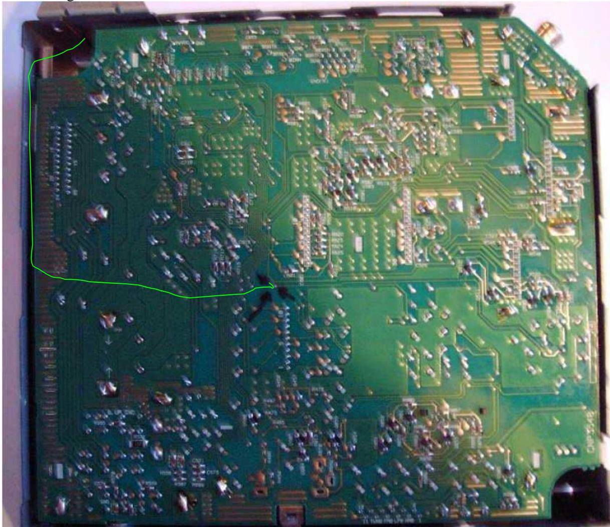
Durch eine der zahlreichen Gehäuseöffnungen den isolierten Schalt draht von außen ins Gerät führen und z.B. wie in grün eingezeichnet, zum Löt punkt auf der Platine führen, am Ende ein paar mm abisolieren und genau dort (Pfeile)
