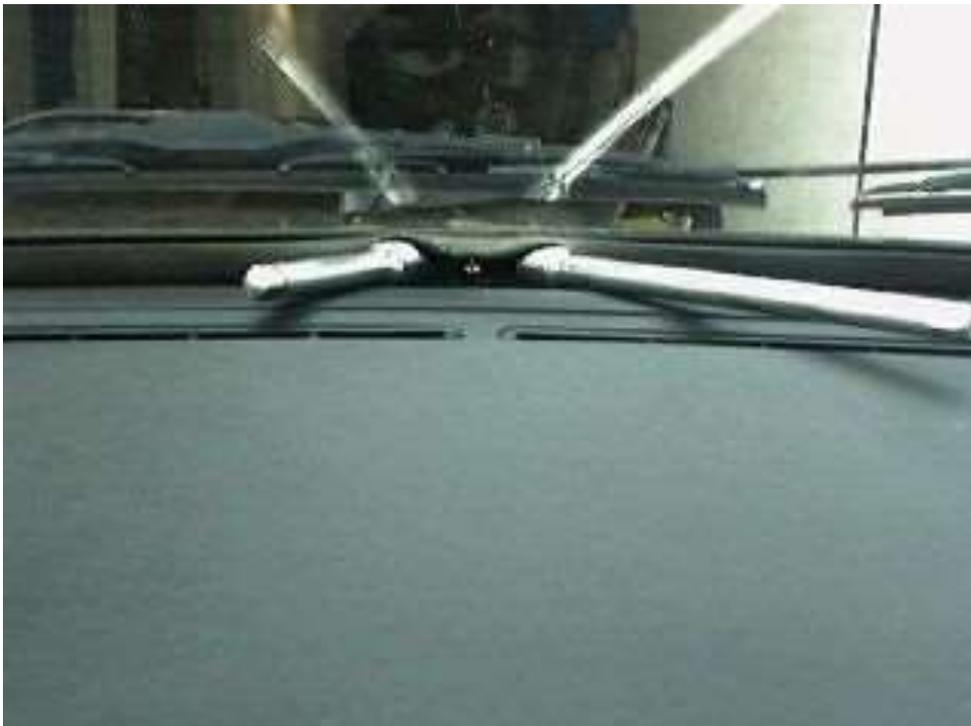
20) Alle sichtbaren Torxschrauben (T20) ausschrauben und die Abdeckung abheben.
