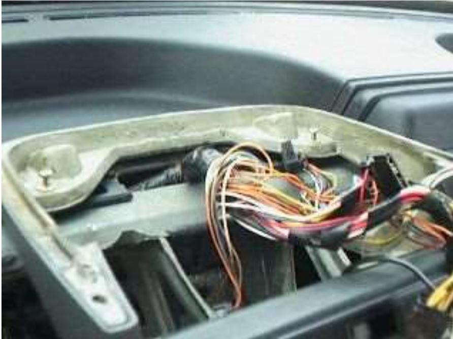
**6) Abdeckungen für Schalter um das Lenkrad entfernen. (Schrauben von unten, T20)**
