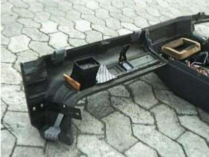
18) Nun können, müssen aber nicht, die Lüftungsdüsenträger von der Mittelkonsole abgeschraubt werden(Schlitzschrauben).
